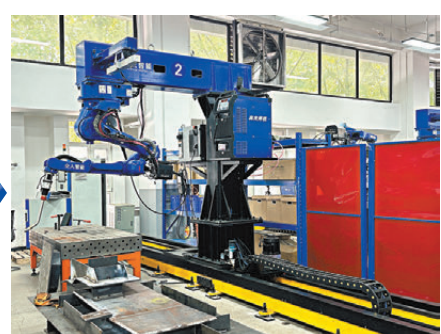
▲▲西安中科光電精密工程有限公司生產的智能焊接機器人。
