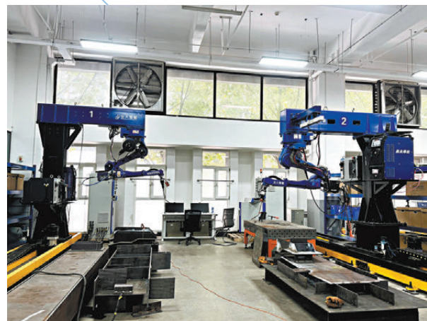
▲▲西安中科光電精密工程有限公司生產的智能焊接機器人。
