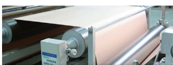
▲銅箔新產品還包括應用於AI伺服器的HVLP3銅箔及IC封裝載板用的超薄VLP銅箔。
