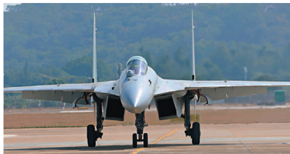
「殲-15T」在機體結構等方面進行了優化，讓艦載機在起飛和着艦時能夠承受更大的力量。
