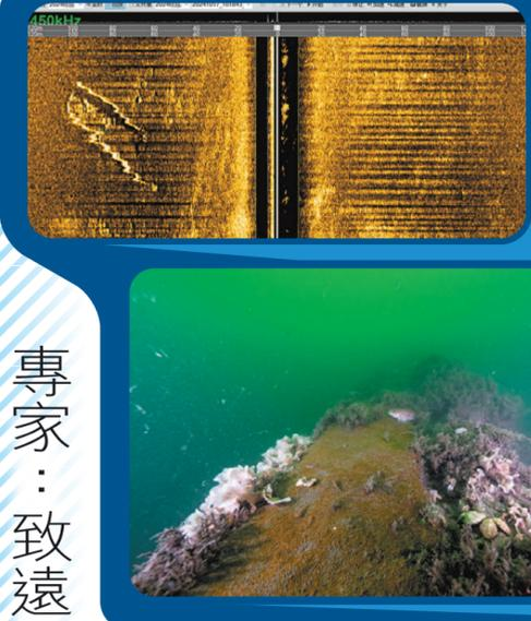
◀側掃聲納觀測到的裸露在海床表面的經遠艦鐵甲堡結構二維圖像。
