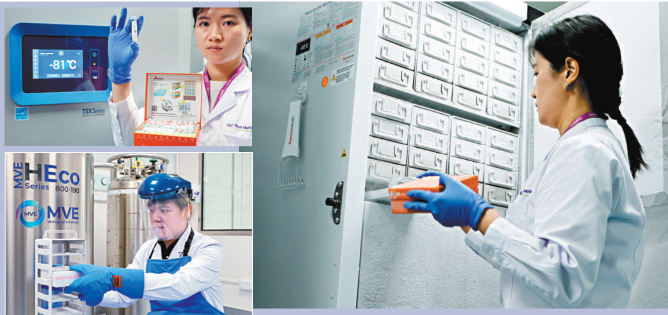
▲試驗所液氮缸溫度為零下150度甚至更低。▲超低溫冷凍儲存櫃為零下80度（左上圖），可儲存超過40萬份樣本。
