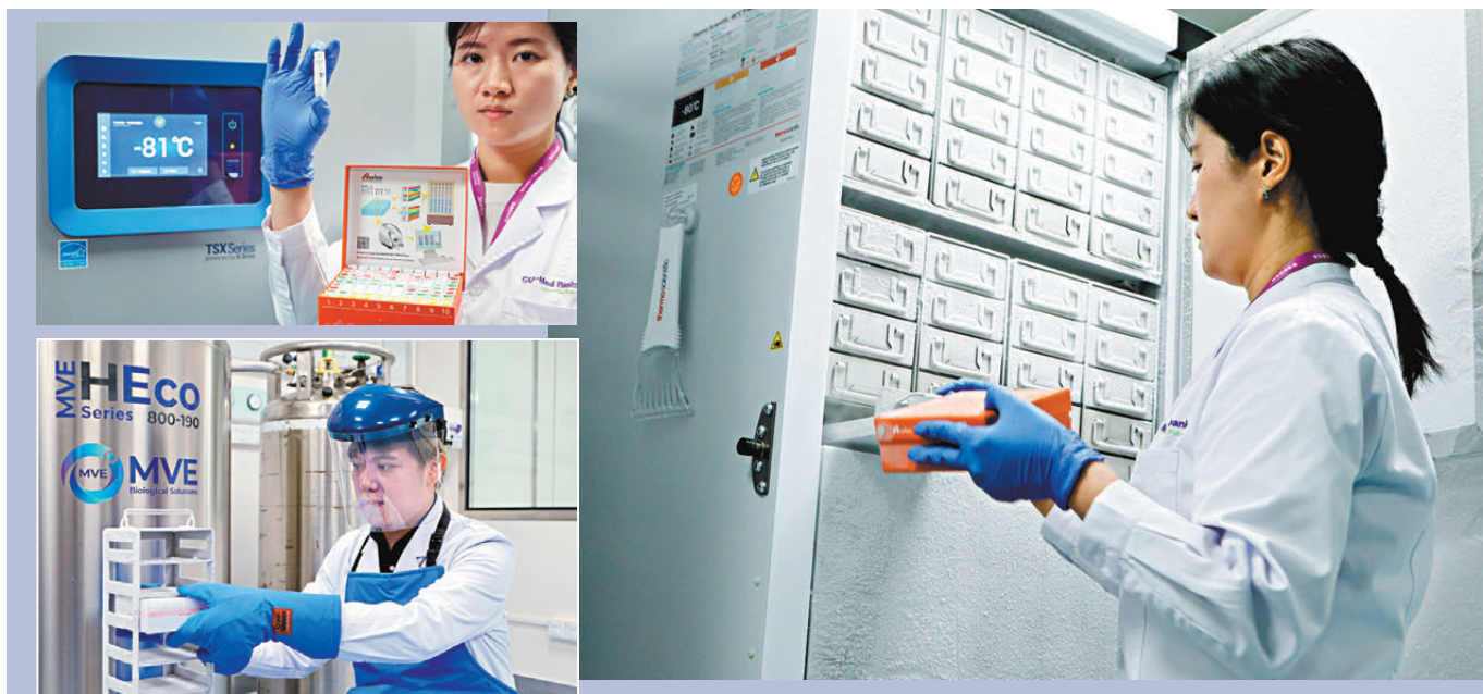
▲試驗所液氮缸溫度為零下150度甚至更低。▲超低温冷凍儲存櫃為零下80度(左上图)，可儲存超過40萬份樣本。
