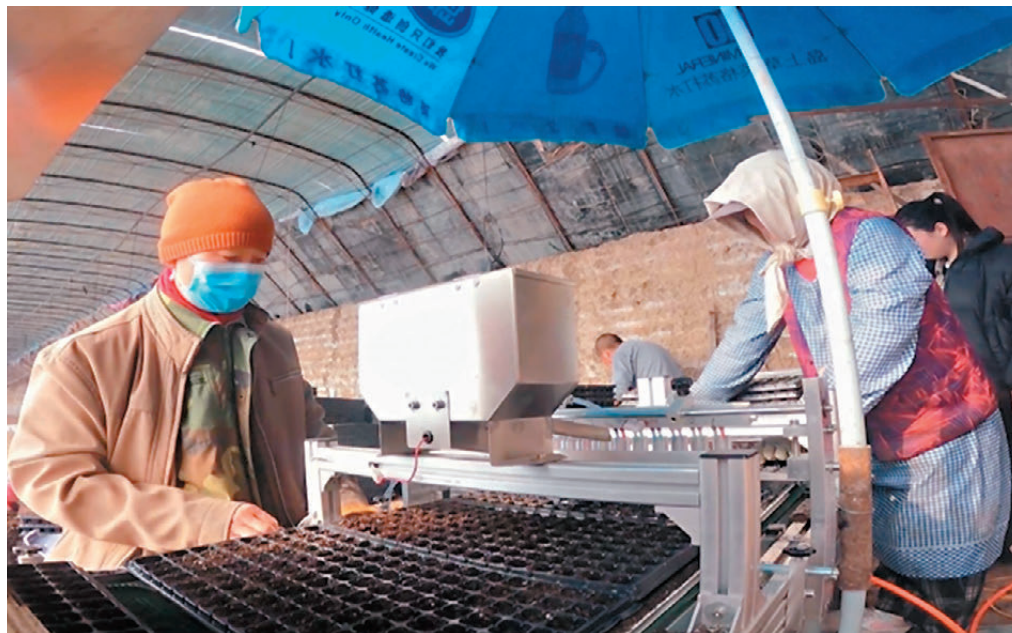
●新疆昌吉回族自治州瑪納斯縣瑪納斯鎮上二工村現代設施農業種植基地內，種植戶正在使用全自動穴盤育苗點種機點種加工番茄苗。
