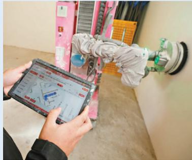
▲▼機械人以雷達掃描牆面，並按預先輸入的圖紙，自動完成髹漆工作。
