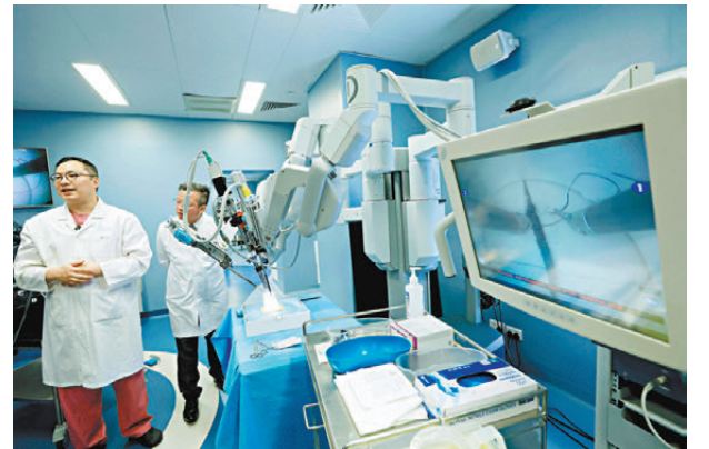
●機械人輔助手術系統中的機械手臂，可多軸向運動，模仿人體手腕轉動和抓取動作，操作靈巧，較傳統微創手術更為精準。香港文匯報記者北山彥攝
