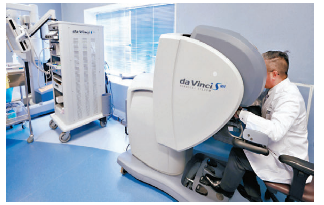
●機械人輔助手術系統配備如螢光影像視覺系統、融合3D模型、術中超聲波影像掃描等，提升手術精準度。香港文匯報記者北山彥攝
