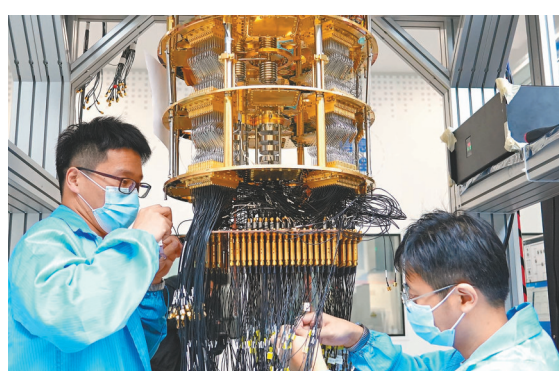
●工作人員正在調試中國第三代自主超導量子計算機「本源悟空」。
