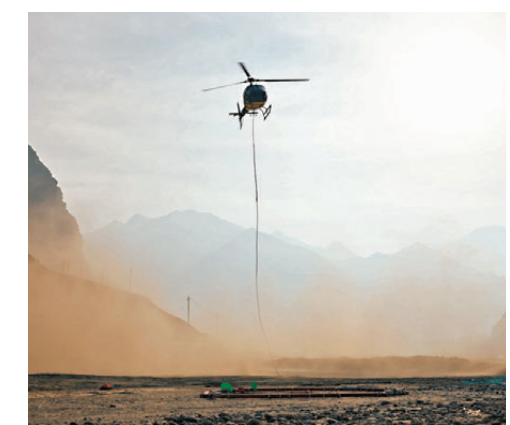
直升機航空大地電磁探測系統在飛行探測作業中。香港文匯報北京傳真
