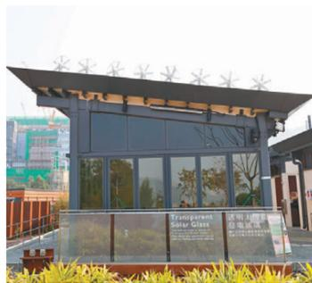
●環保村建築物頂裝設小型風車，以及圍欄的透明太陽能玻璃，分別利用風能和太陽能產生電力。
