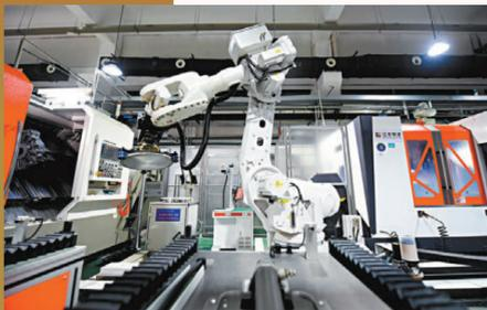
▲在寧波江豐電子材料股份有限公司分析檢測中心，工業機器人在自動化產線加工芯片靶材。資料圖片
