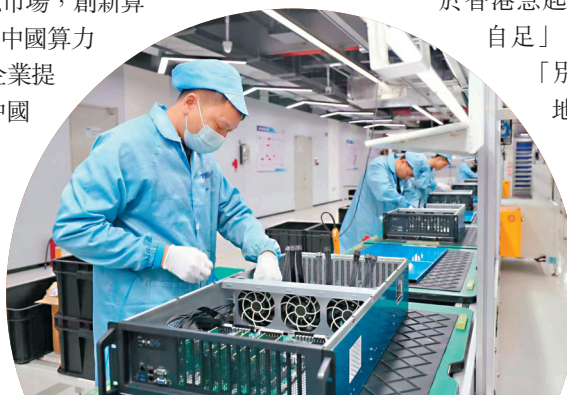
●中國的算力服務、算力裝備出海有着廣闊前景。圖為算力工廠裏，工作人員在組裝、測試算力設備。 香港文匯報北京傳真
