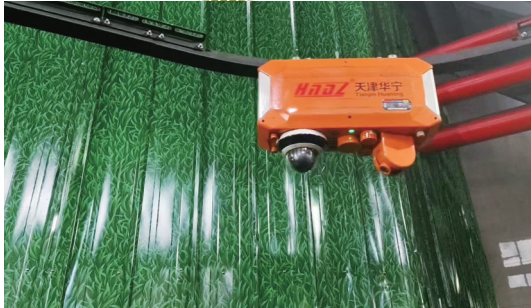
●東泰鑫源煤業有限公司智能巡檢機器人。
