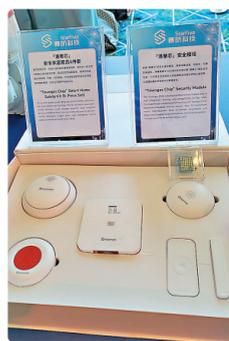
「港華芯」智能家居產品 5 件套 產品包含燃氣報警器、煙霧探測器、漏水探測器、門磁及 SOS 按鈕，可自動監測異常環境並預警，智能聯動開關，全方位守護用戶居家安全。內置的「港華芯」安全通信模組，具有高集成度、高安全、高兼容等優點。
