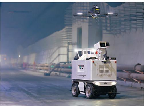
清相機自動拍攝彩色及紅外線熱圖像，並即時將圖像傳送到無人車的AI模組進行缺陷檢測分析。
