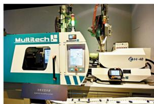
●圖為利用注射式成型技術批量生產塑料製品的注塑機。
