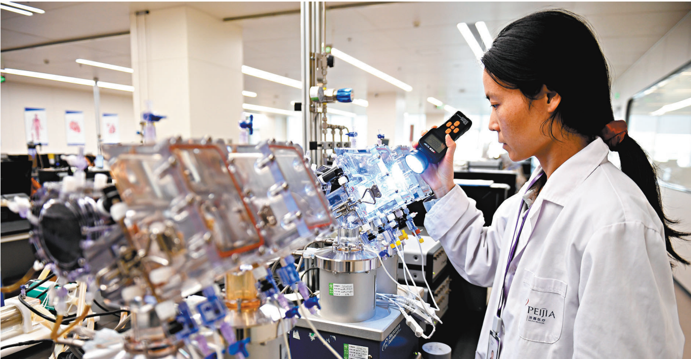
●3月21日，在位於蘇州工業園區的沛嘉醫療科技（蘇州）有限公司測試實驗室裏，檢測人員使用頻閃儀檢查正在疲勞測試中的人工心臟瓣膜開閉合形態。資料圖片
