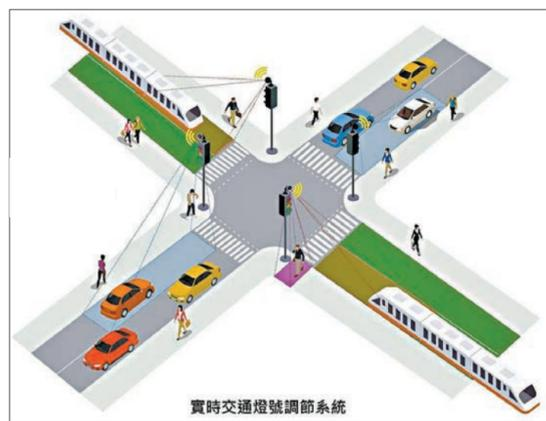
●AI實時分配的紅綠燈，以感應器探測智慧綠色集體運輸系統，車流及人流。土木工程拓展署圖片
