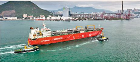
●加注船是全球最大的液化天然氣運輸加注船，可裝載3萬立方米液化天然氣，每小時加注能力達1,650立方米。
