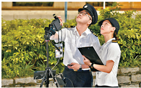
●譚綺雲（右表示，紅外線夜視攝錄裝置可在陰暗環境中清晰捕捉高層滴水源頭。
