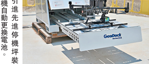
●發展局引進先進停機坪裝置，為無人機自動更換電池。
