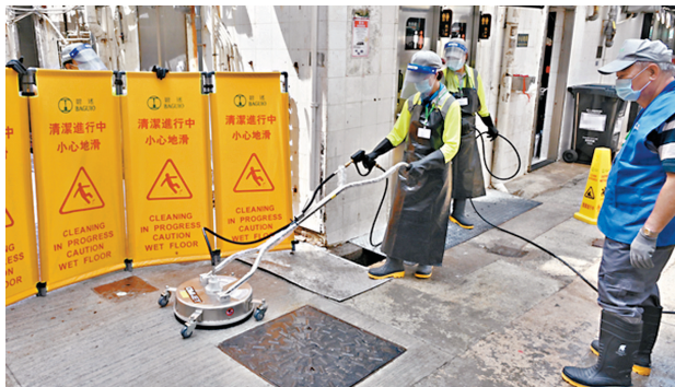
●高速清洗盤讓清潔工人能更有效清除路面上的頑固污漬，同時減輕工作負擔。
