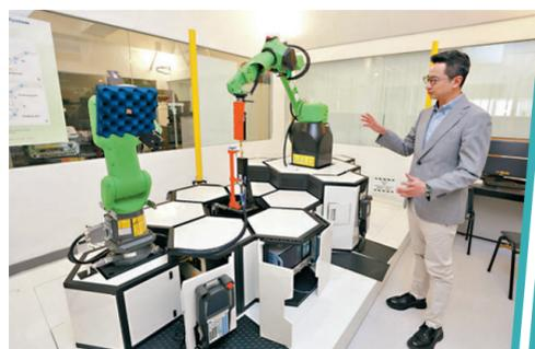
「雙機械臂」高解析度天線測量系統。
