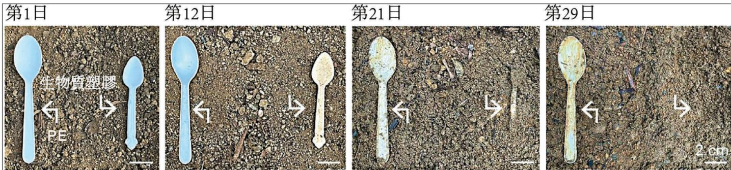
●團隊研發的「新型物料」（圖中右邊的匙羹）以源自天然植物基因的分離結構設計而成。實驗結果顯示，當它與圖中左邊以聚乙烯（Polyethylene, PE）製成的匙羹一同埋入一般土壤中，「新型物料」可在最短29天內完成降解。
