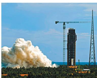
●12日，中國在文昌航天發射場成功組織實施長征十號系列運載火箭第二次繫留點火試驗。網上圖片
