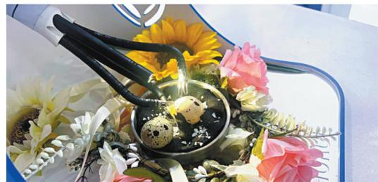
●術鏡展台的工作人員正操作機器臂處理一枚生鵪鶉蛋，僅剝掉硬殼部分而完整保留蛋膜，蛋液絲毫不漏。香港文匯報記者郭瀚林 攝
