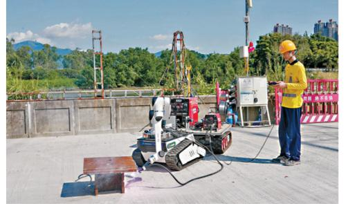
●燒焊機械人透過輸入參數即可完成標準焊接。網誌圖片
