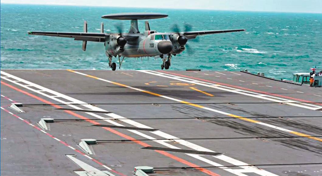
◀空警-600艦載預警機在海軍福建艦阻攔着艦。圖為飛機放下尾鉤的着艦前瞬間。網上圖片
