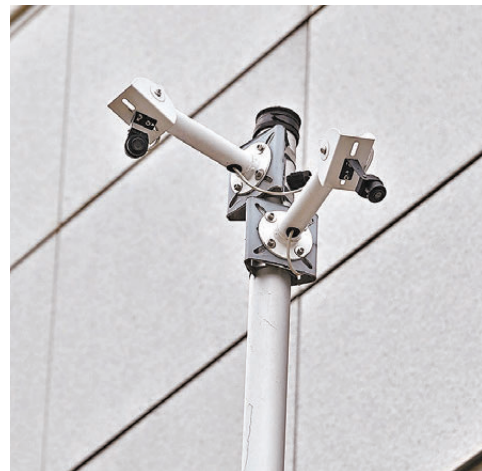
●實時交通燈號調節系統通過加設在路口的感應器收集實時交通數據，由人工智能分析人流和車流，更合理分配車輛和行人的綠燈時間。
