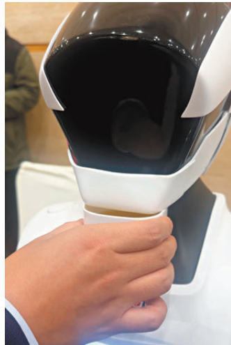
▲ 擁有電子鼻的「嗅博士」正在識別液體。
