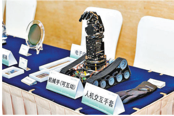
▲ 機器手掌搭載的柔彈性傳感薄膜快速捕捉力反饋，毫秒間調整力度完成輕握動作。
