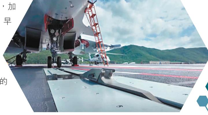
▲福建艦跳過目前國外航母以蒸汽為動力的傳統彈射方式，直接跨越到了更為先進的以電能為動力的電磁彈射。 視頻截圖
