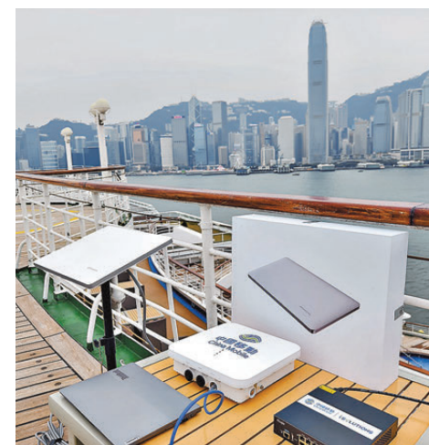
●圖為去年測試利用「千帆星座」低軌寬頻信號連接中國移動香港的雲Wifi平台。 資料圖片
