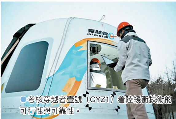
●穿越者壹號（CYZ1）載人飛船試驗艙全面總裝。
