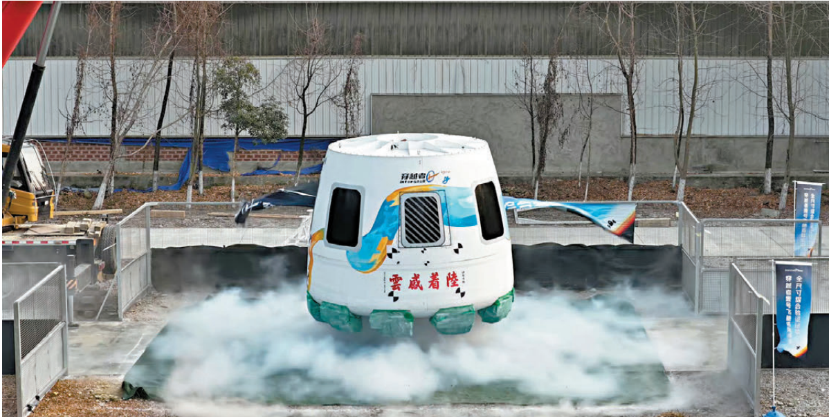
●穿越者壹號（CYZ1）全尺寸載人飛船試驗艙着陸緩衝綜合驗證試驗。
