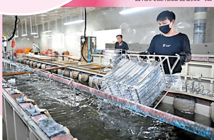
●工人在河南省鹿邑縣中俊實業有限公司的廠房內對用於連接刷毛和刷柄的鋁管進行氧化處理。 新華社
