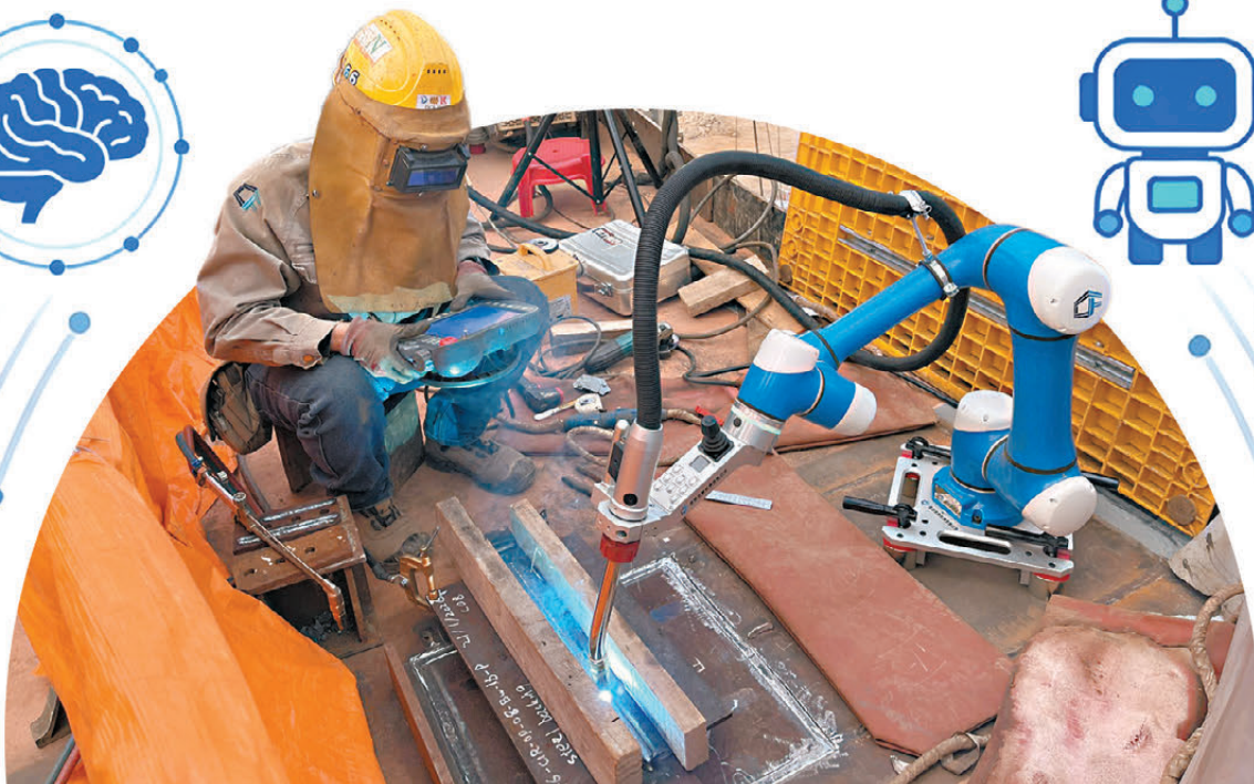
▲建造業引入新科技，圖為建造業議會焊接技能大赛向參與世界技能大赛的選手，示範使用智能機械人協助工作。 建造業議會Fb圖片
