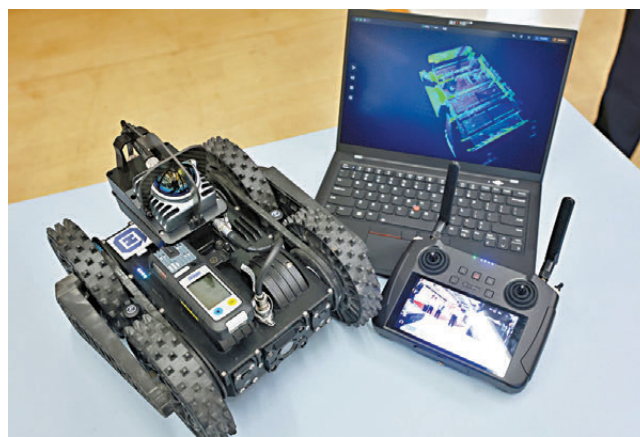
●小型無人偵測車體積輕巧，可進入各類狹窄密閉空間執行任務。香港文匯報記者郭木又攝
