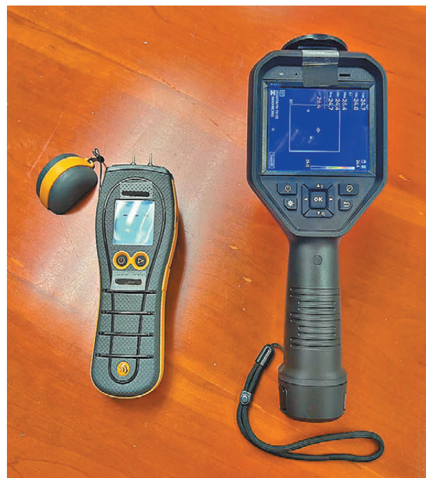
●新檢測程序下，食環署在第一階段除繼續使用電子濕度儀外，還新增紅外線熱成像儀(右)分析滲水情況和初步確定滲水源頭。香港文匯報記者李芷珊攝
