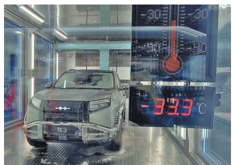
●比亞迪零下30攝氏度低溫倉裏展示汽車在零下33度的充電情況。
