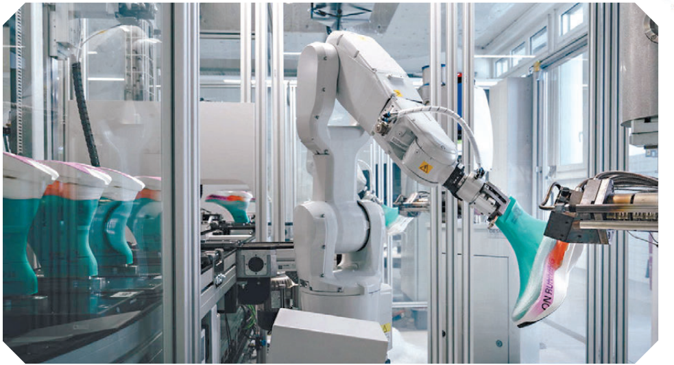
LightSpray™ 以機械臂自動噴織方式，將跑鞋鞋面生產時間縮短至3分鐘。網上圖片
