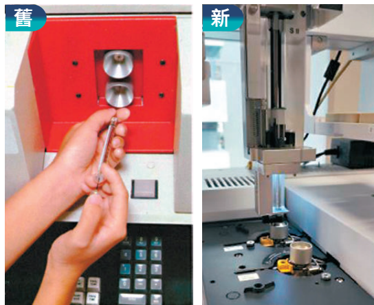
●舊款氣相色譜儀手工進樣口 ●新款氣相色譜儀自動進樣器
