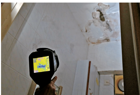
●紅外線熱成像儀顯示藍色範圍(溫度較低)，即為滲水區域。 香港文匯報記者涂穴 攝
