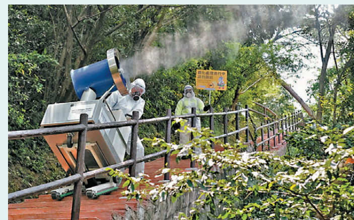
●食環署職員用「電動爬梯機」運載「噴霧器」進行霧化滅蚊。 資料圖片
