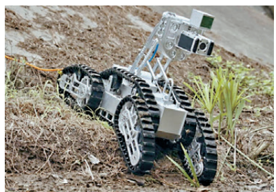
●履帶式全地形渠道檢測機械人「百變探哥」。 渠務署圖片
