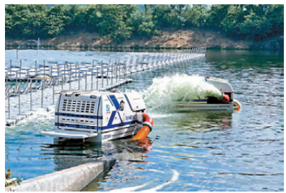
●強力排水機械人「龍吸水」。 渠務署圖片
