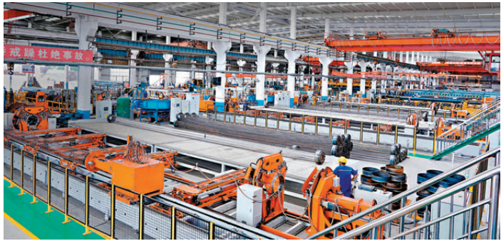
●建華在拉斯海瑪海事城自由區興建該地區首座預應力高強混凝土管樁廠，預計年產100萬噸建材。圖為建華上海智能製造管樁自動化生產線。 建華官網圖片
