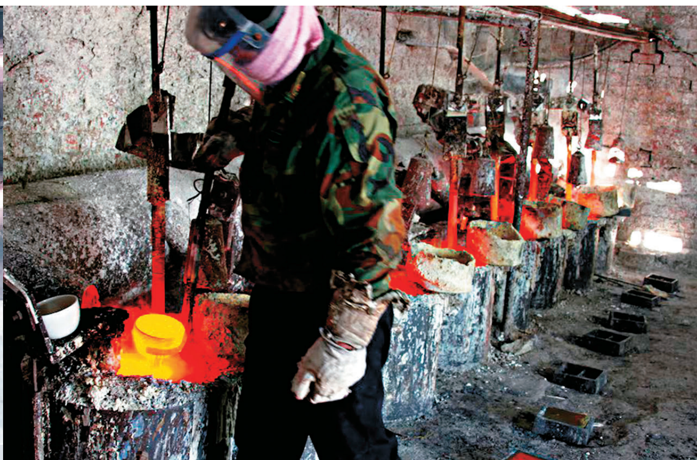
●在中國內蒙古自治區達茂旗附近，一名工人準備將稀土金屬鋼倒入模具中。
