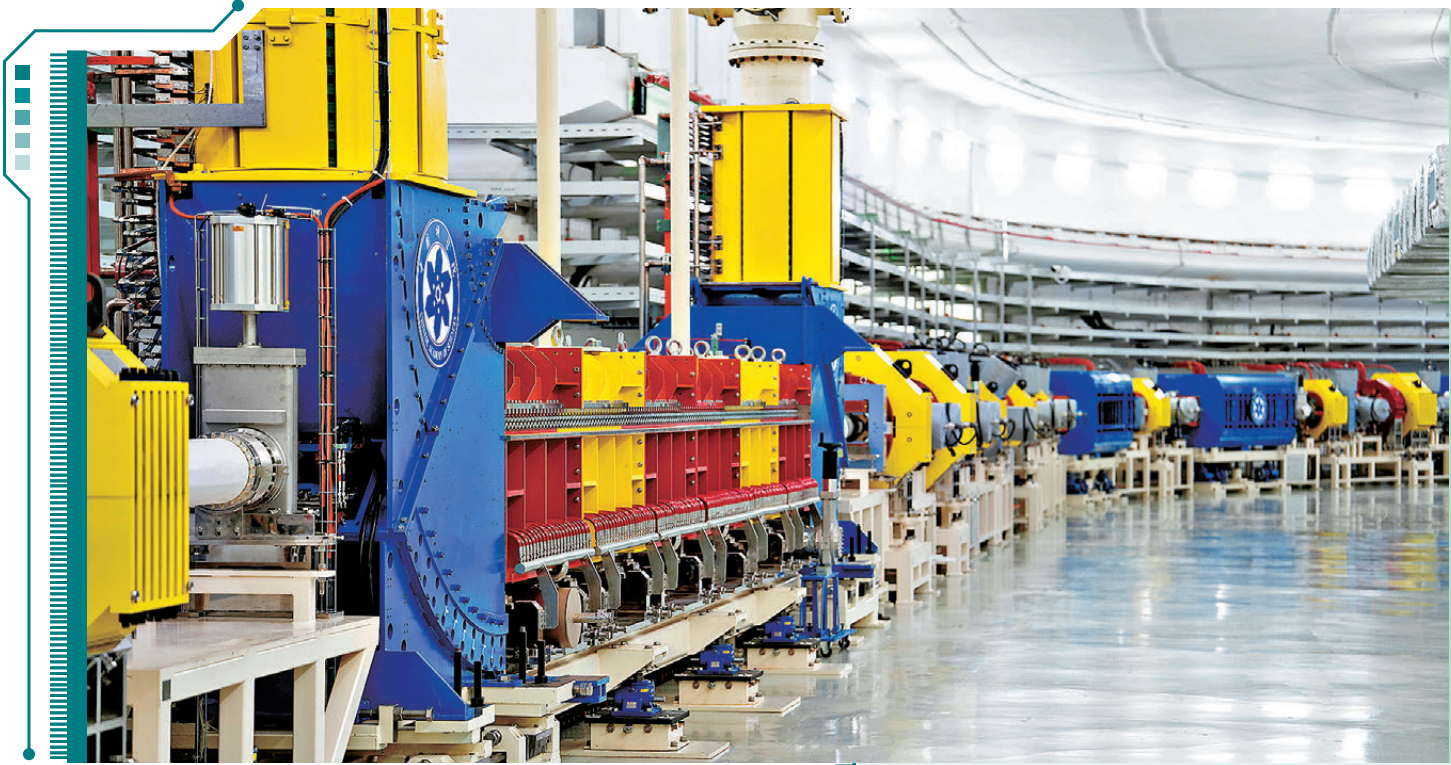
▼強流重離子加速器裝置的超導離子源設備。新華社
