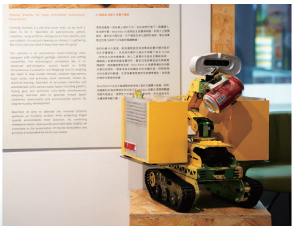
▲Beachbot AI團隊研發的自主海灘清潔機械人亮相展場，機械人搭載人工智能識別系統，可自動分類回收垃圾。
