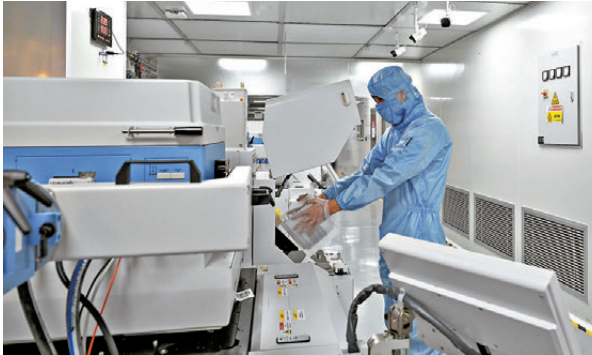
●工作人員在位於上海市浦東新區的張江芯片測試公共服務平台晶圓測試車間內，將樣品放入面向人工智能芯片測試的探針台中。
