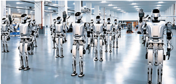
●早前，在佛山一工廠裏，多台夸父人形機器人進行一致性測試。
